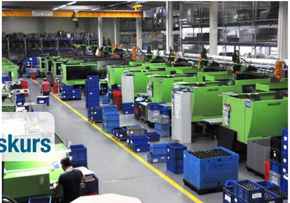
Auf insgesamt 60 Spritzgießmaschinen fertigt Nifco-KTS Teile für anspruchsvolle kinematische Baugruppen. Engel victory ist der bevorzugte Maschinentyp.
