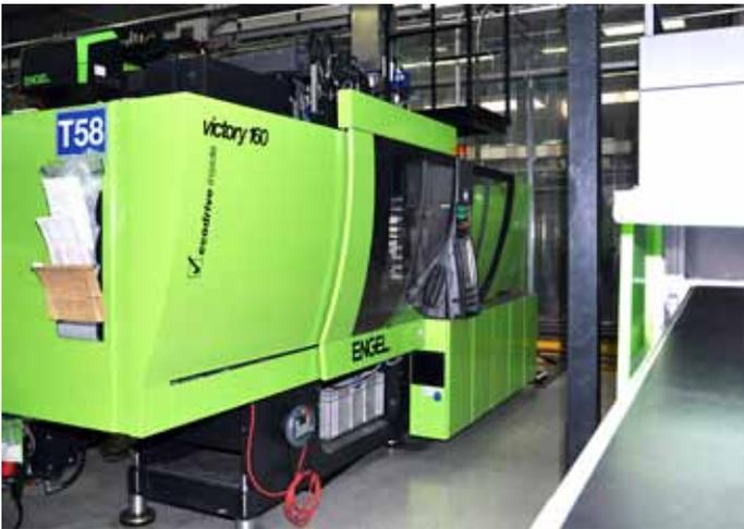
Im Zwei-Komponentenspritzguss werden auf der *Engel victory 160 combi-Spritzgießmaschine* Polycarbonat und ABS verarbeitet. Alle jüngeren *Engel victory-Spritzgießmaschinen* sind mit der Servohydraulik *ecodrive* ausgestattet.
