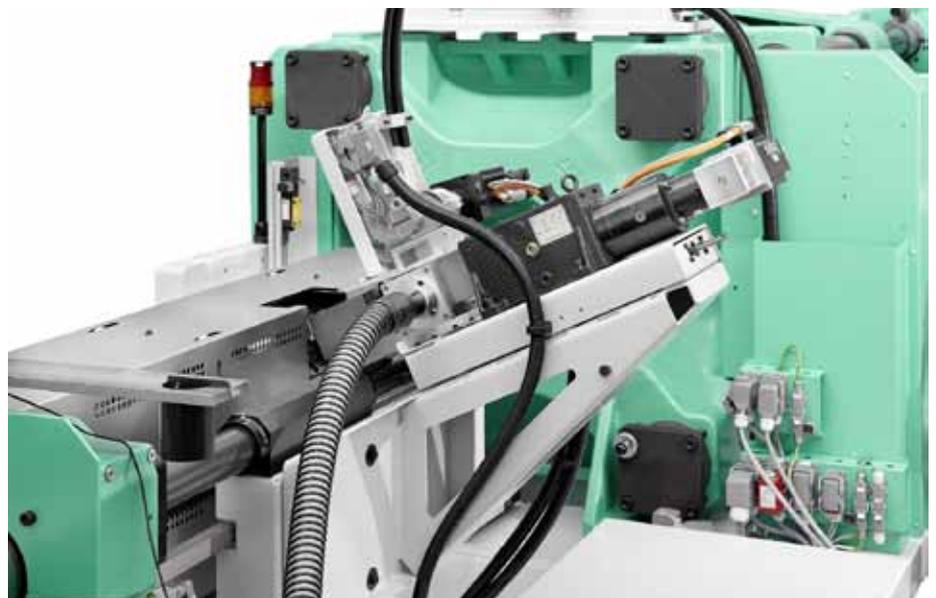
Beim Langfaser-Direktspritzgießen werden die Fasern über eine Seitenbeschickung an der Spritzinheit direkt in die flüssige Schmelze zugeführt.
