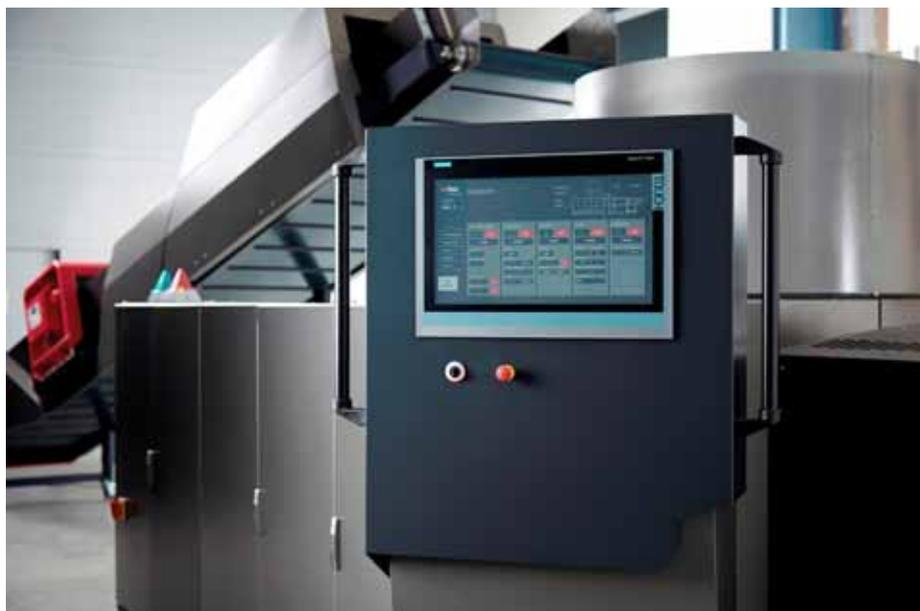
Das Steuerungsdisplay ist höhenverstellbar und drehbar ausgeführt. Die Bedienoberfläche wurde bedienfreundlich und weitgehend selbsterklärend ausgeführt. Die Internet-Fähigkeit der Steuerung bietet sämtliche Optionen der Fernwartung und Fernüberwachung. Foto: Artec
