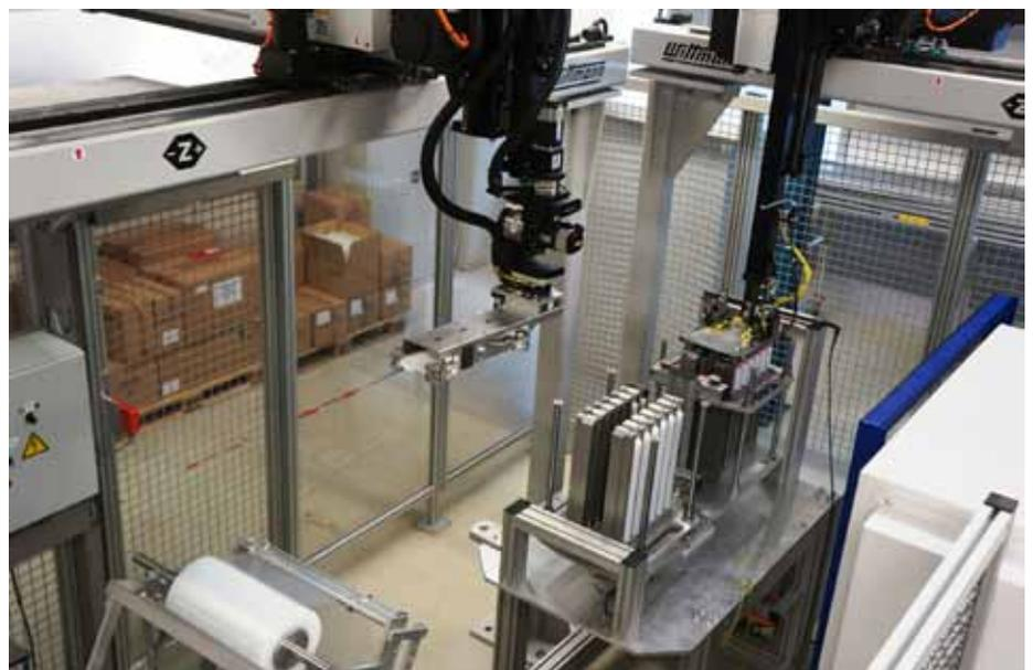
Aus der befüllten Magazinstation übernimmt ein zweites Handlinggerät jeweils einen Stapel und legt ihn in die Schlauchbeutel-Verpackungsstation ein.
