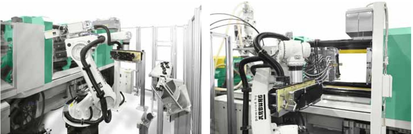
Die ebenen Einleger werden in neuer Technik im Greifersystem prozesssicher und materialschonend aufgewärmt und bei genauer Umformtemperatur an das LIPA-Werkzeug übergeben. Fotos: Arburg
