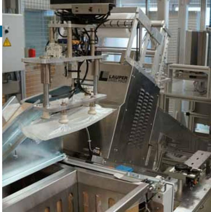
Unmittelbar nach der Fertigstellung der Schlauchbeutel-Verpackung nimmt *Handling 2* die verpackten Messlöffel nach einem Greiferwechsel wieder auf und übergibt sie in eine Transportbox.
