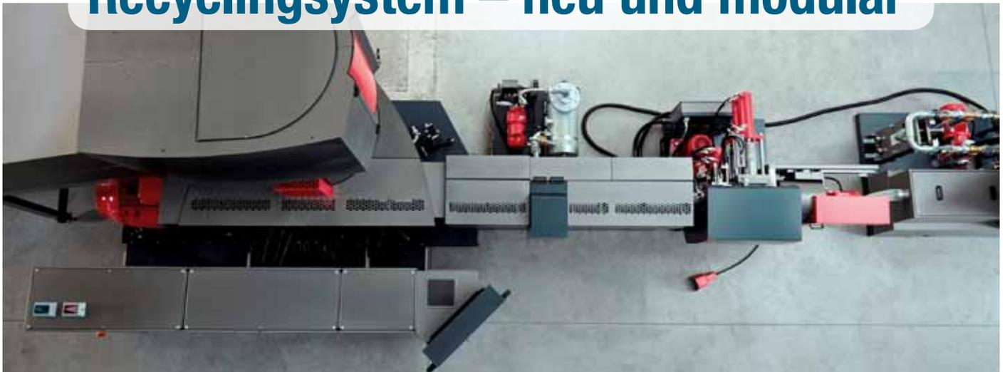
Blick von oben: Die Modularität der Anlagentechnik ist durchgängig für alle Anlagenkomponenten realisiert, die je nach gewünschter Anlagenleistung individuell kombiniert werden können.
