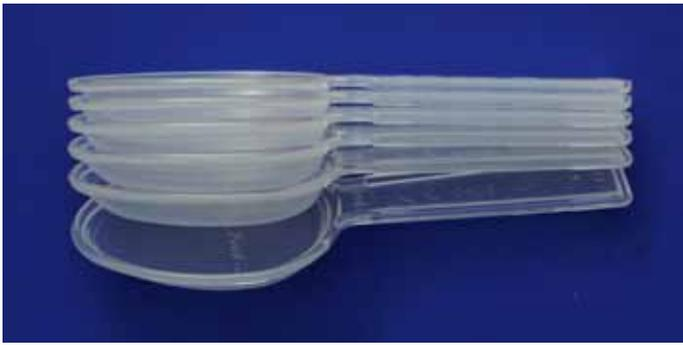
Eine verzugsfreie, gerade Löffelkontur ist die Voraussetzung zur Stapelung von jeweils 130, alternativ 160 Teilen in den Teilemagazinen an der Maschinenrückseite. Die Stapelung erfolgt getrennt entsprechend der Kavitätenzahl in 12 Magazinen. Die Magazinstation ist um 180 Grad drehbar doppelt ausgeführt.
