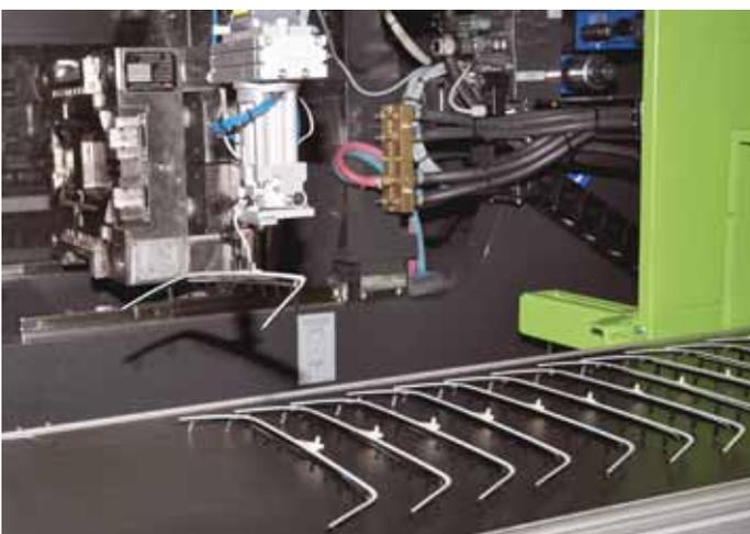
Ein *Engel viper-Linearroboter* entnimmt die Bauteile aus dem Werkzeug. Der Roboter ist in die Steuerung der Spritzgießmaschine integriert, was zu besonders kurzen Zykluszeiten beiträgt.
