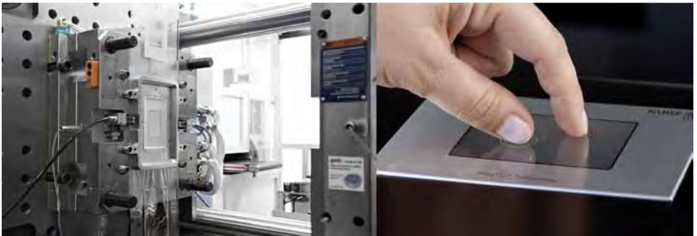
Kompakte Produktionszelle mit einer *Systec 210*, die IML- und IMD-Technik miteinander kombiniert. Hierauf entsteht effizient in einem Schuss ein multitouchfähiges Display. Auf der schließseitigen Werkzeugeite wird der Rahmen des 5-Zoll-großen Displays mit der IMD-Einheit direkt beim Spritzgießen dekoriert. Fotos: Sumitomo (SHI) Demag
