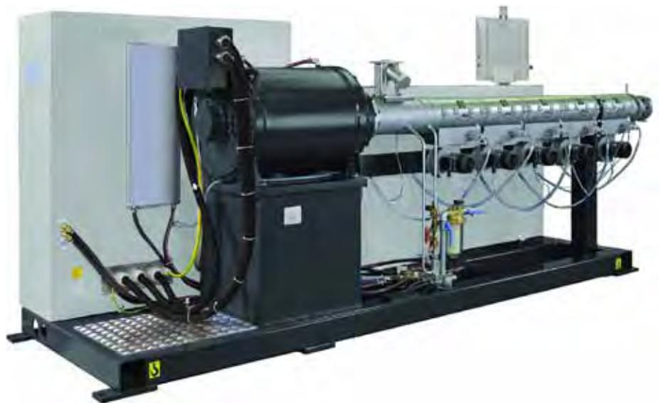
Die neue *solEX-GL* (getriebelos)-Serie ermöglicht dank ihres High-Torque-Motors vibrations- und geräuscharmen Betrieb bei höchsten Ausstoßleistungen in der PO-Rohrextrusion.
