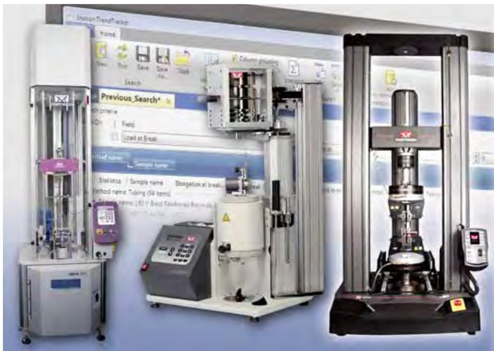
Im Mittelpunkt des Messeauftritts von Instron auf der K 2013 stehen hoch entwickelte Messsysteme zur Erfassung der Fließfähigkeit von Thermoplasten, der mechanischen Eigenschaften und des Bauteilverhaltens unter statischer und dynamischer Last. Neue Peripheriegeräte und Softwaremodule helfen der Kunststoffindustrie, die Effizienz und Präzision der Messungen zu steigern. Foto: Instron
