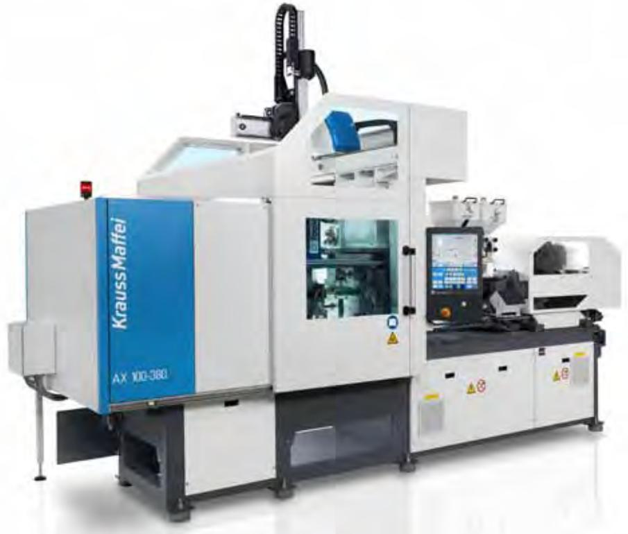
Maschinen der AX-Baureihe sind prädestiniert für das physikalische Schäumen mit MuCell.
