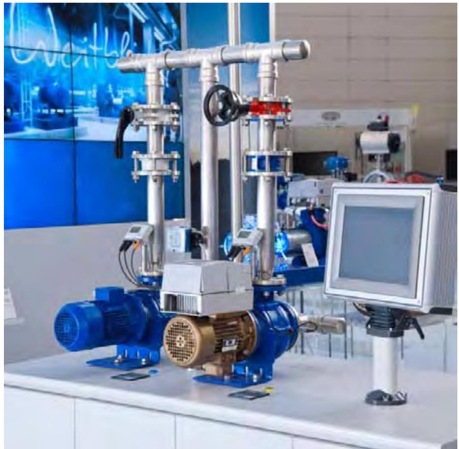
Demoanlage für den Vergleichstest von IE2- zu IE4-Motoren für Pumpen, die in der Kühlenergieversorgung zum Einsatz kommen. Foto: ONI
