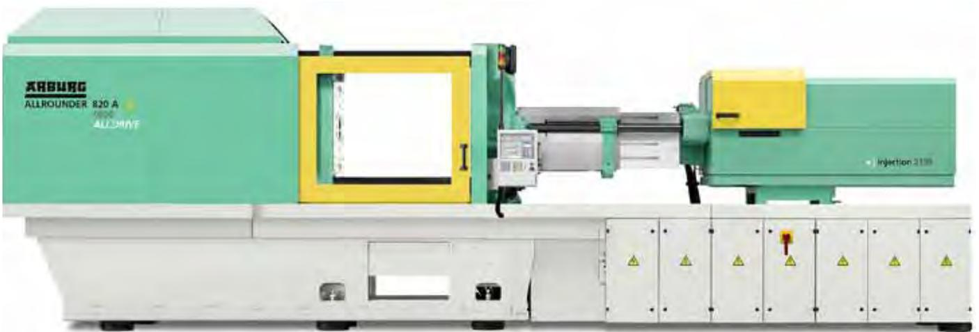
**Weltpremiere:** Für den neuen elektrischen Allrounder 820 A wurde sowohl die 4 000-kN-Kniehebel-Schließereinheit als auch die elektrische Spritzeinheit der Größe 2100 neu entwickelt. Fotos: Arburg
