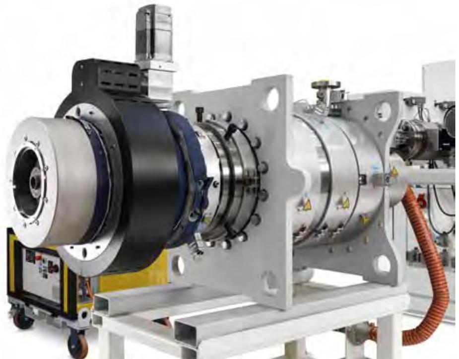
**QuickSwitch-Anlage von KraussMaffei Berstorff mit Mehrschichtrohrkopf und IPC-Technologie.**
