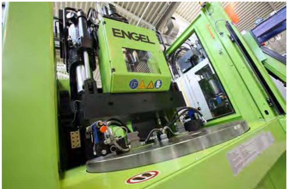
In einem 4-fach-Werkzeug produziert Engel während der K dreidimensional anspruchsvolle Stecker auf einer vertikalen Engel insert rotary-Rundtischmaschine.
