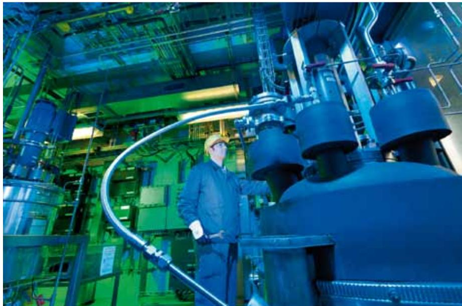
Pilotanlage in Leverkusen für die Herstellung von Polyolen mit CO<sub>2</sub>.
